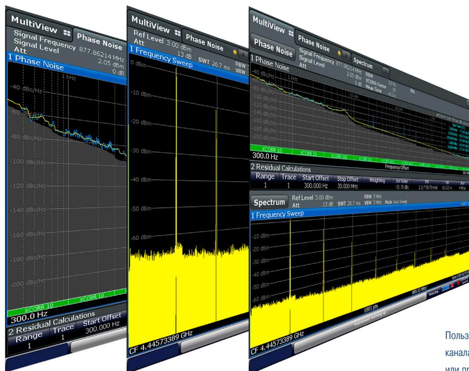
Пользователи могут переключаться между измерительными каналами анализатора спектра и анализатора фазового шума или просматривать оба канала одновременно
