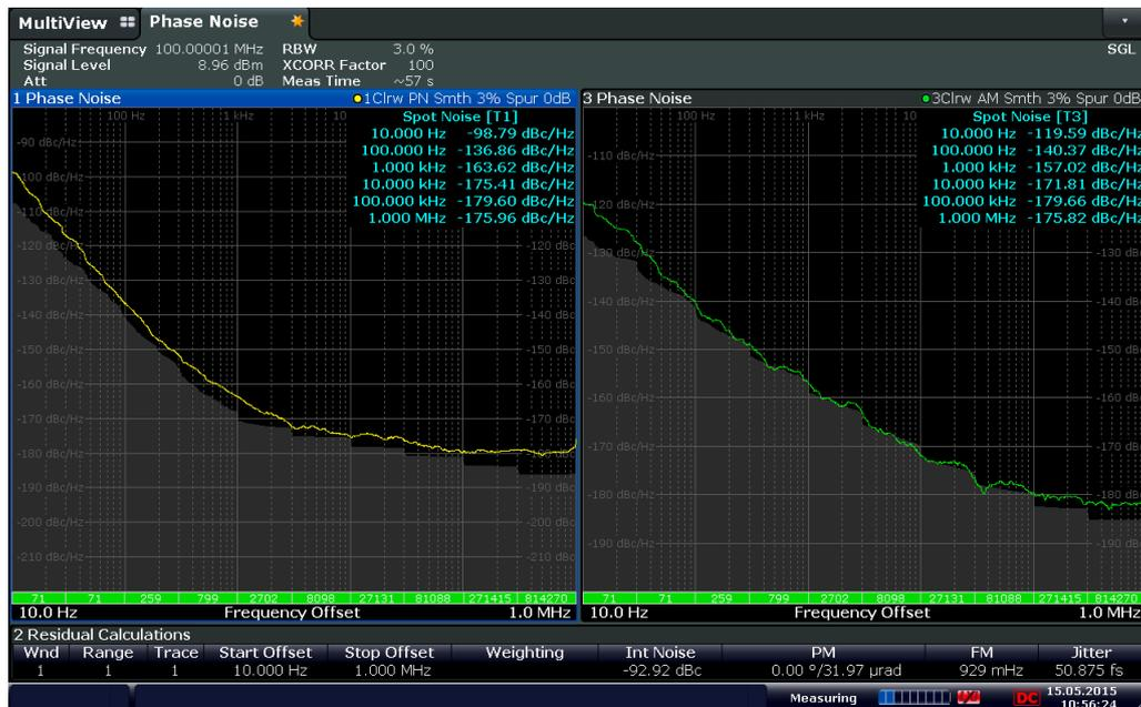
Анализатор R&S®FSWP способен одновременно измерять фазовый и амплитудный шум. Результаты измерений могут отображаться в отдельных окнах или совместно в одном окне (серая область: улучшенная корреляция прибора R&S®FSWP, зеленая кривая: амплитудный шум, желтая кривая: фазовый шум.).
