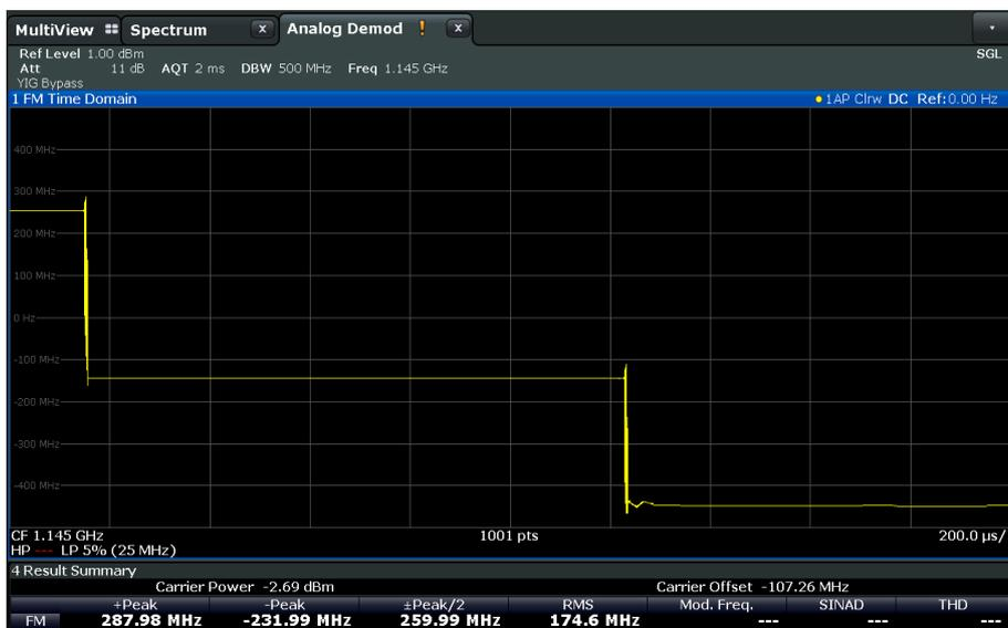
Широкополосный частотный анализ для синтезирующего устройства. Кривая представляет собой зависимость частоты от времени. Это позволяет пользователям измерять время переключения и осуществлять контроль частот.
