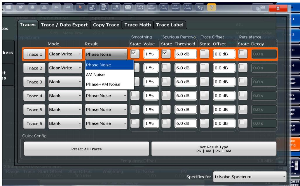
В меню настроек кривой пользователи могут назначать кривые для измерений фазового и/или амплитудного шума. Они также могут настроить режимы удаления паразитных сигналов, сглаживание кривых или отображение кривых в режиме послесвечения.
