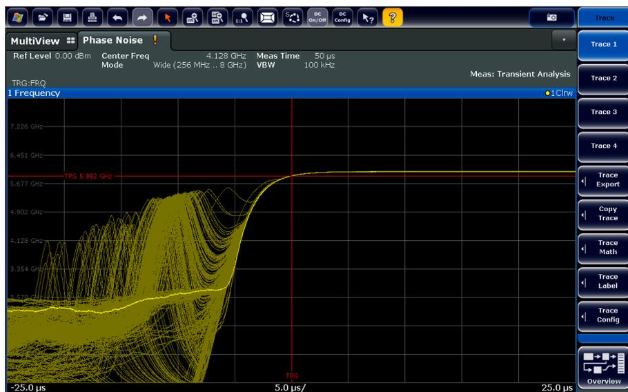
Переходные процессы в синтезаторе частот, отображаемые в режиме послесвечения. Красная горизонтальная линия указывает пороговую частоту запуска, а вертикальная линия — смещение запуска. Яркая желтая кривая представляет текущее измерение, а тусклые желтые кривые — все предыдущие измерения.
